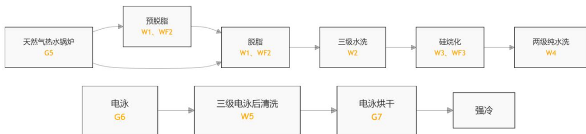
图 2-3 电泳段工艺流程及产污环节图
