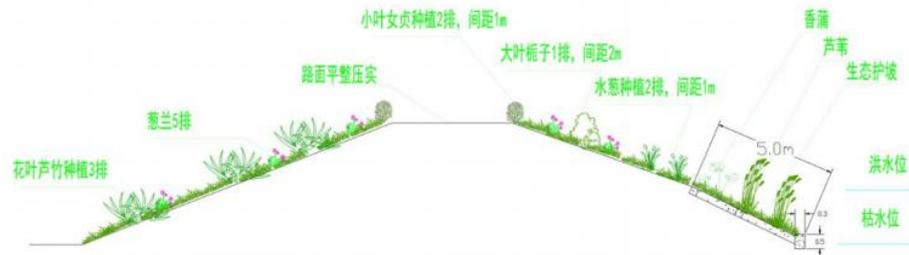
图 2-1 马家吉河消落带与生态护岸建设工程断面设计图
